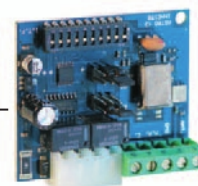
ASTRO 43/2 SAW radio ricevente da innesto
